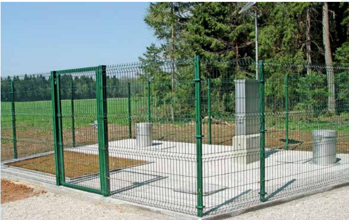
Samodejno merilno mesto za podzemno vodo v Vogljah Automated groundwater measuring site
